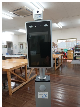
サーモカメラ（標識画像）
